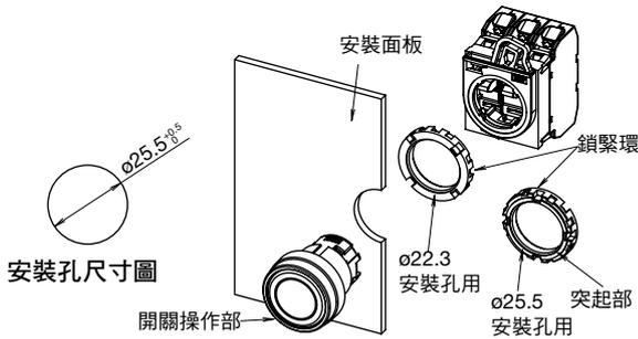
安裝時，請注意，如下圖所示將鎖緊環的突起部確實的鎖緊在面板內。
